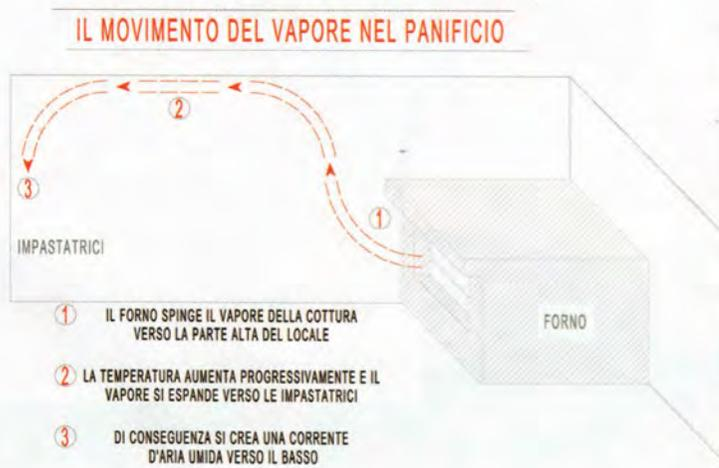
Fig. 1 - Il movimento del vapore all'interno del laboratorio al momento dello sfornamento
